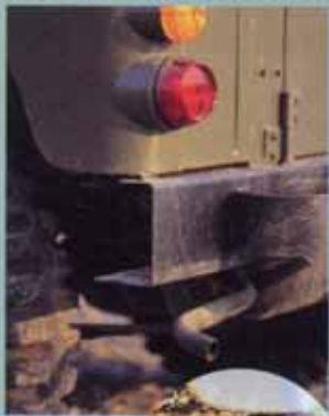
リアのランプも片側シングルに代わって、三菱Jeep用を装着。リアバンパーはファイナルメンバーに被せ、ボディマウントとフック固定ボルトで共締めし、ピントルフックを装着している。曲がったマフラーは、ジムニーの証。
