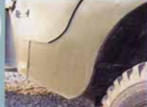
ボディサイドパネルのサイドシル部分は、わずかに下側へ鉄板を張り足して延長。ホイールハウスに見える縁が、ジープボディのホイールハウスとジムニーのフロアとの継ぎ目である。
