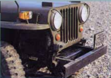
特徴的なCJ3Aのフロントグリルは、ジムニーのボディマウントにうまく装着。ヘッドライト下のウインカーがCJ3Aオリジナルだが、車検をパスできないため三菱ジープのコンビネーションランプをフェンダー上に備えている。
