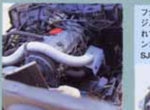
ゴデービルに代わって、エンジンルームに収まるのはF10A。5年開火が入れられなかったエンジンだが、簡単に始動できたのには驚く。そんな抜群の信頼性も、魅力の1つと言えるだろう。
